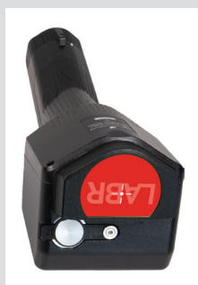
Guardian 501 LABR Thiết bị xác định hạt nhân phóng xạ nhanh, hiệu quả
